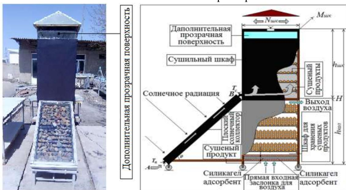
Рисунок 17. Устройство МСКСУЕКс дополнительной прозрачной поверхностью.
