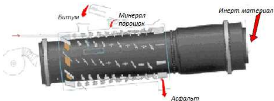
Рисунок 2. “DOUBLE BARREL” тип сушильно-смесительный барабан
