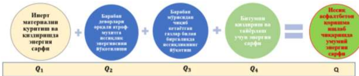
Рисунок 11. Энергозатраты при производстве горячей асфальтобетонной смеси
