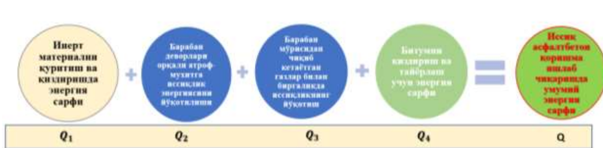
11-rasm. Issiq asfaltbeton qorishma ishlab chiqarishda energiya sarfi
