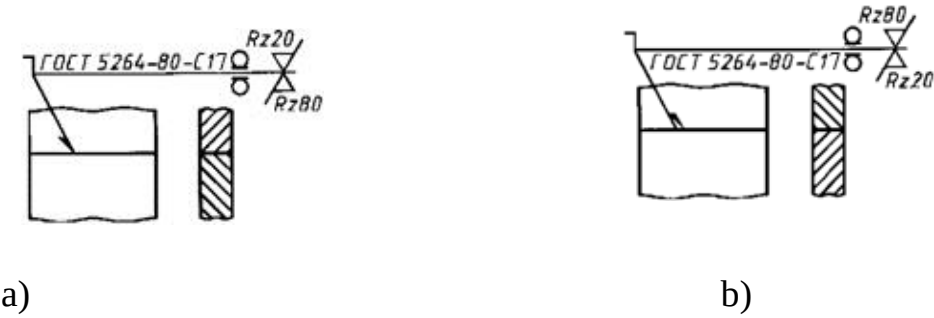
3- rasm. S17 birikma payvand chokninng shartli belgisi:
