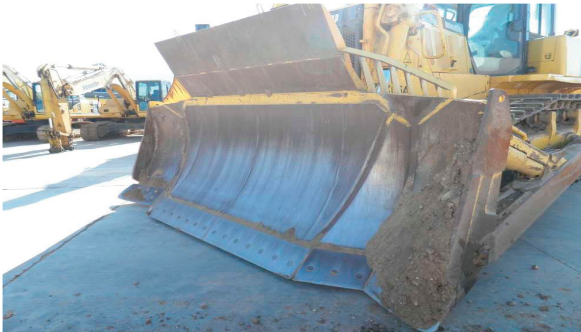
Рис. 1. Бульдозер D655EX-16 с отвалом типа «Сигма»
