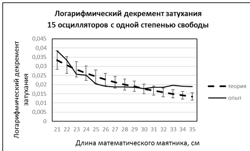
Рис. 2. Логарифмический декремент затухания 15 осцилляторов с одной степенью свободы
