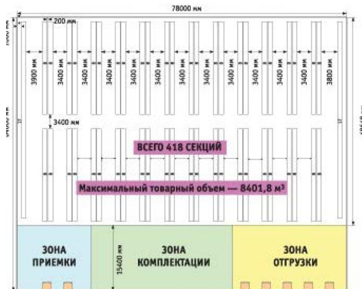
Рис. 2. Изменение товарного объема при уменьшении длины стеллажной секции до 2,7 м
