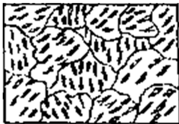
14-su`wret. Bosatilg`an troostit mikrostrukturasinin` sxemasi.
