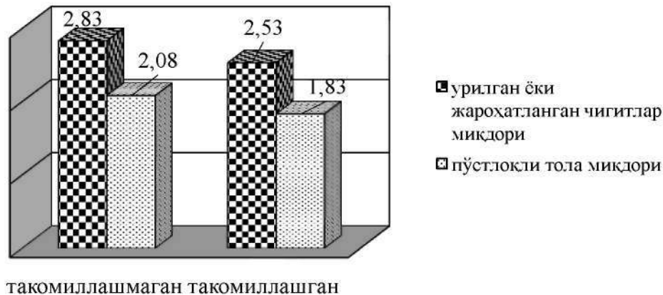
2-расм. Пахта толаси таркибидаги урилган ёки жароҳатланган чигитлар ва пўстлокли тола миқдорининг ўзгаришига тозалаш ускунасининг таъсири.
