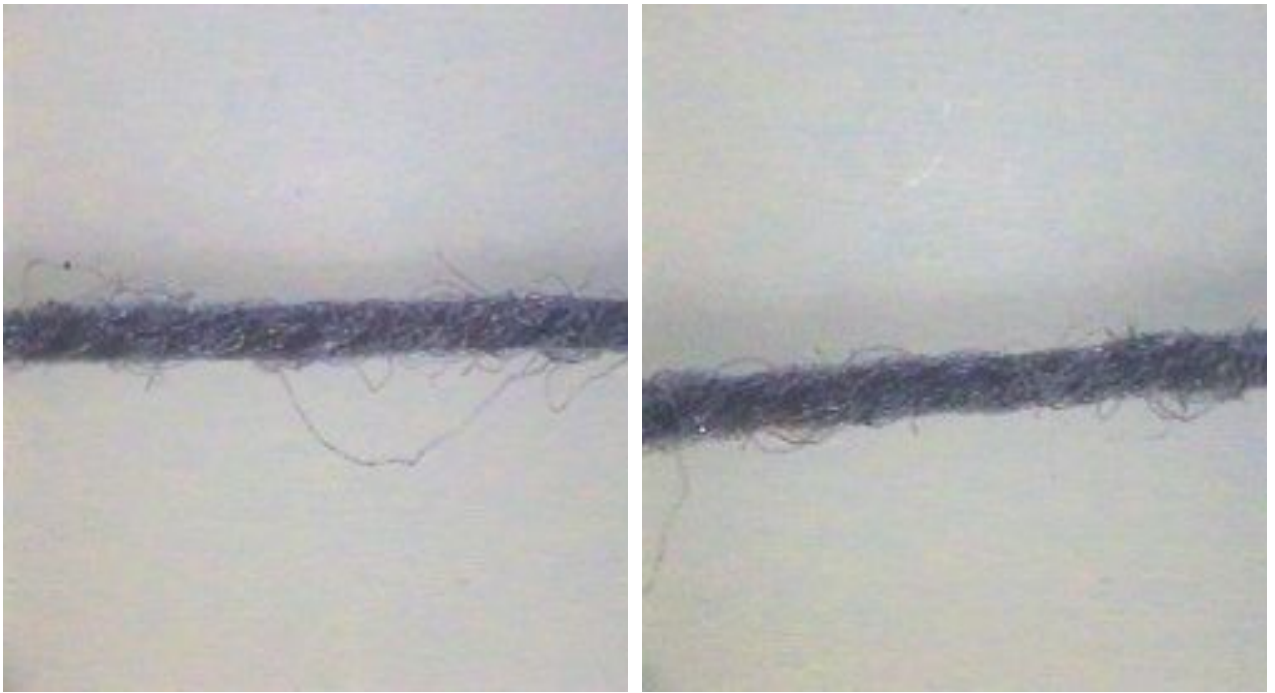
3.6-расм. 40 х/б савдо рақамли саноат тикув ипларининг ишлов берилгандан сунг юза текислиги фотоси
