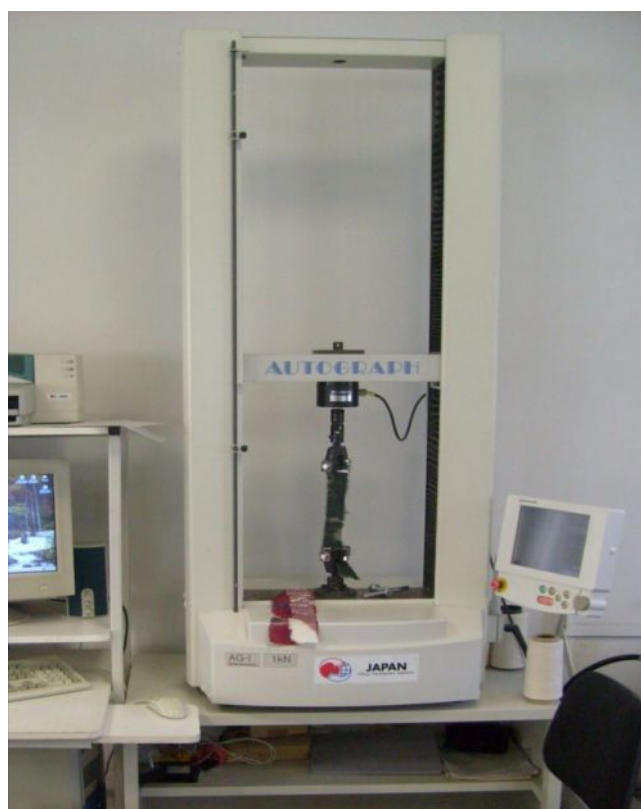
2.2-расм. Тўқимачилик материаллари ва пакетининг узилиш характеристикаларини аниқлайдиган AUTOGRAPH-Ўасбоби
