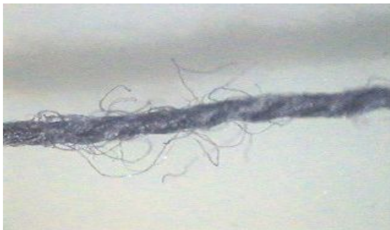
3.4-расм. 40S савдо рақамли саноат тикув иплари юзасининг нотекислиги
