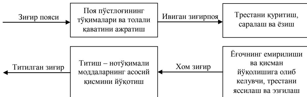
1.12-расм. Зиғирга бирламчи ишлов беришнинг умумий схемаси.
