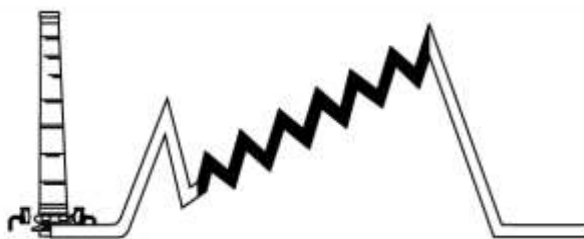
5-rasm. Bo'sh naychaga ip o'rash sxemasi (oq chiziq ip uchlari, qora chiziq o'ramdagi ip)
