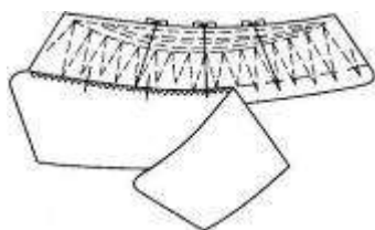
23-rasm. Ustki va ostki yoqalarni bostirma chok bilan tikish
