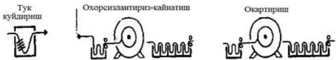
33-rasm. Oxorsizlantirish-qaynatish jarayonlari birgalikda olib boriladigan yarim uzluksiz pardoqlashga tayyorlash sxemasi
