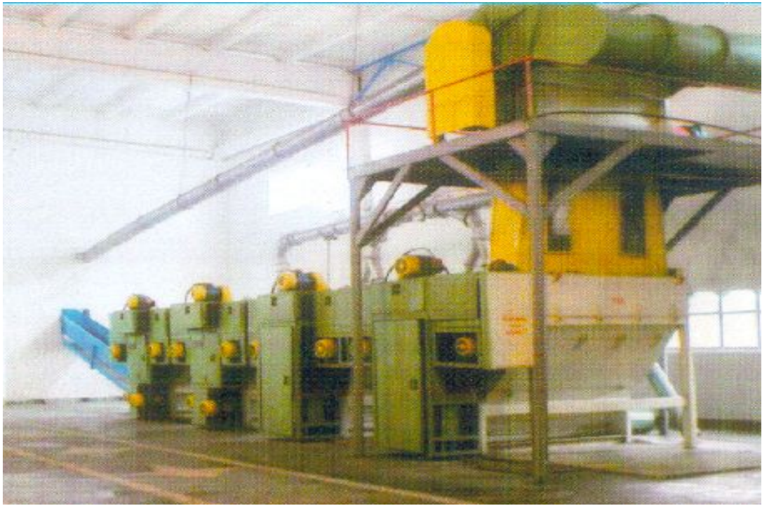
6-расм. УХК-сексиялари ўрнатилган тозалаш бўлими кўриниши
