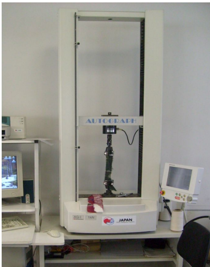
2.4-расм. Тўқимачилик материаллари ва пакетларининг ёрилиш тавсифларини аниқлаш учун AUTOGRAPH AG-I прибори
