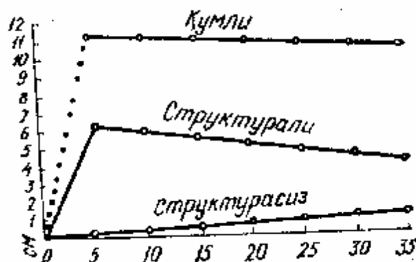
34-rasm. Qumli, strukturali va strukturasiz turpoqlarning suv o'tkazuvchanlik xossasini ko'rsatuvchi diagramma.
