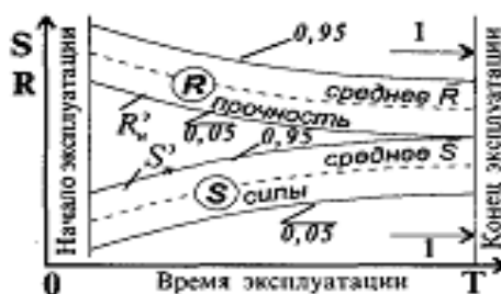
Рис. 2. Схематическая интерпретация условия надежности конструкций: Z – запас надежности; \bar{S} , \bar{R} – математическое ожидание сил и прочности; \hat{S} , \hat{R} – стандарт
