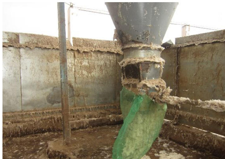
2.10-расм. “Митан пахта тозалаш” АЖ корхонасида ЦС-6 чанг ушлагичида толали чиқиндиларни ушлаб қолиш ҳолати.
