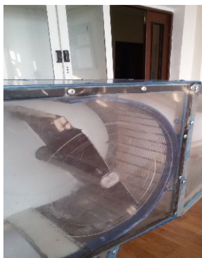
3.9-расм. Чанг таркибидан толали чиқиндиларни ажратиб олувчи қурилмани ишчи қисми.
