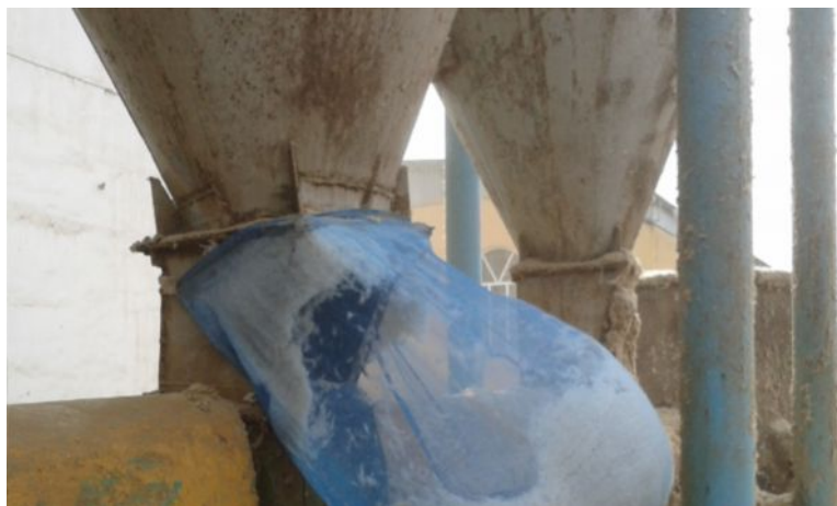
2.9-расм. “Митан пахта тозалаш” АЖ корхонасида ВЗП-1200 типдаги чанг ушлагичдан толали чиқиндиларни ушлаб қолиш ҳолати.
