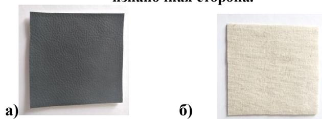
**Рис.2 Фотография образца № 2- экокожа с дублирином. а) лицевая сторона, б) изнаночная сторона.**
