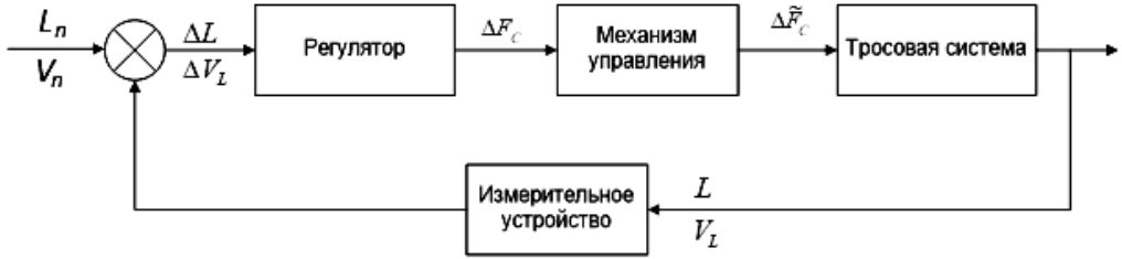
Рис. 1. Принципиальная схема системы регулирования
