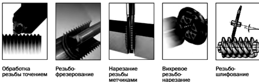
Рис. 2. Методы обработки резьбы резанием
