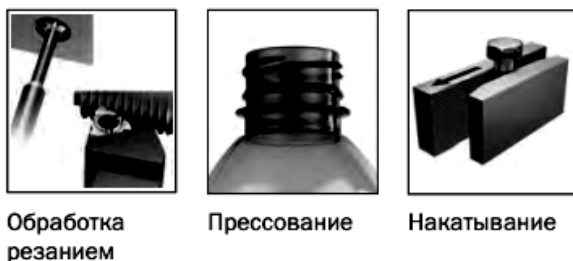
Рис. 1. Различные методы получения резьб
