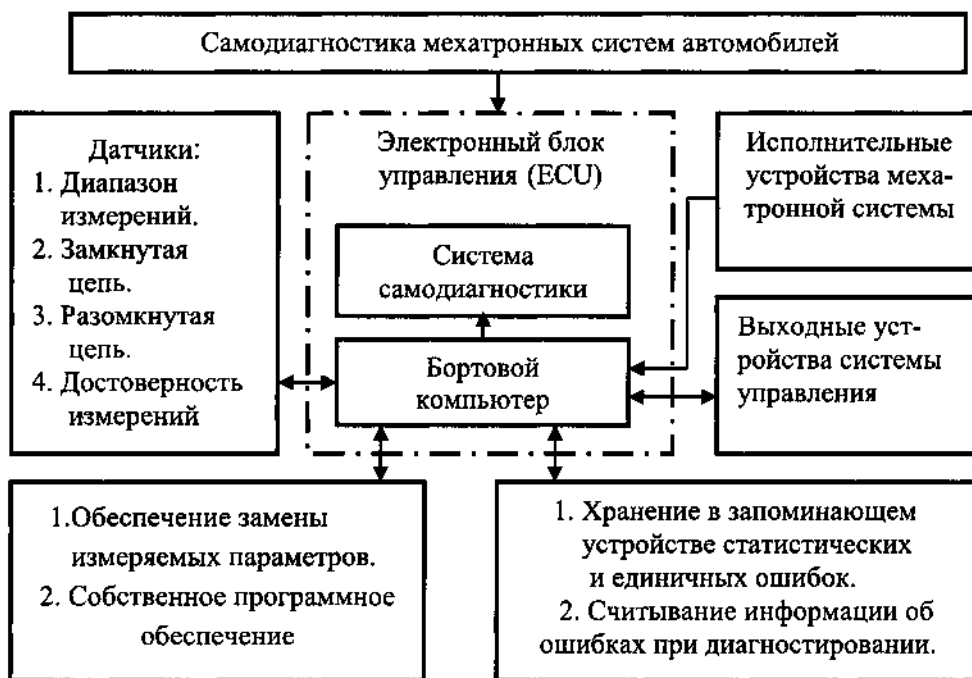
Рис.21.2. Структурная схема самодиагностики мехатронных систем автомобилей
