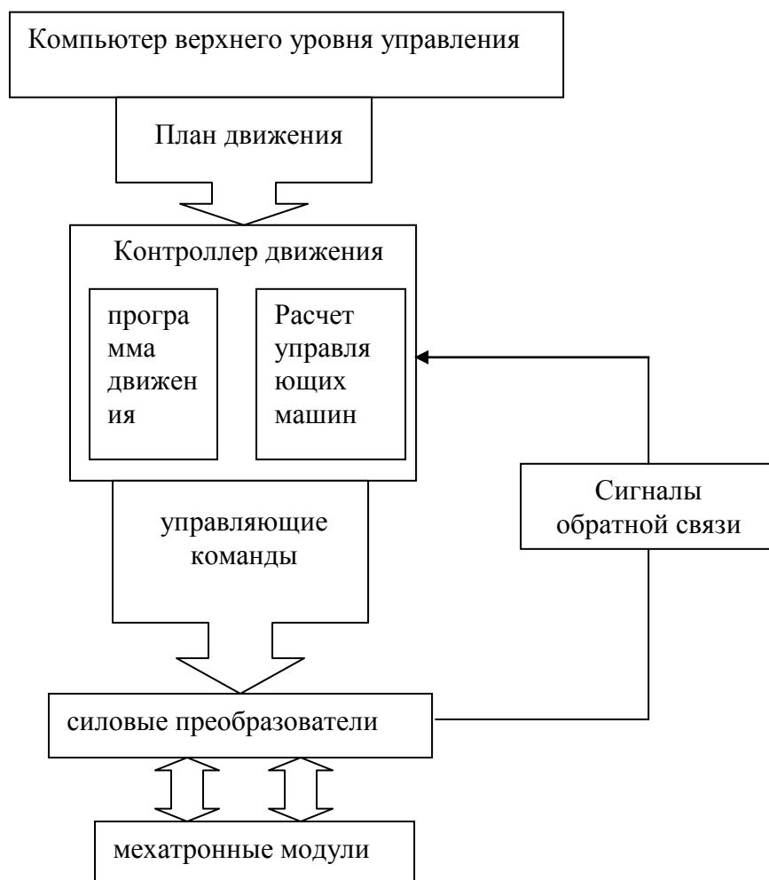
Рис.3.2. Система управления мехатронными модулями на базе контроллера движения
