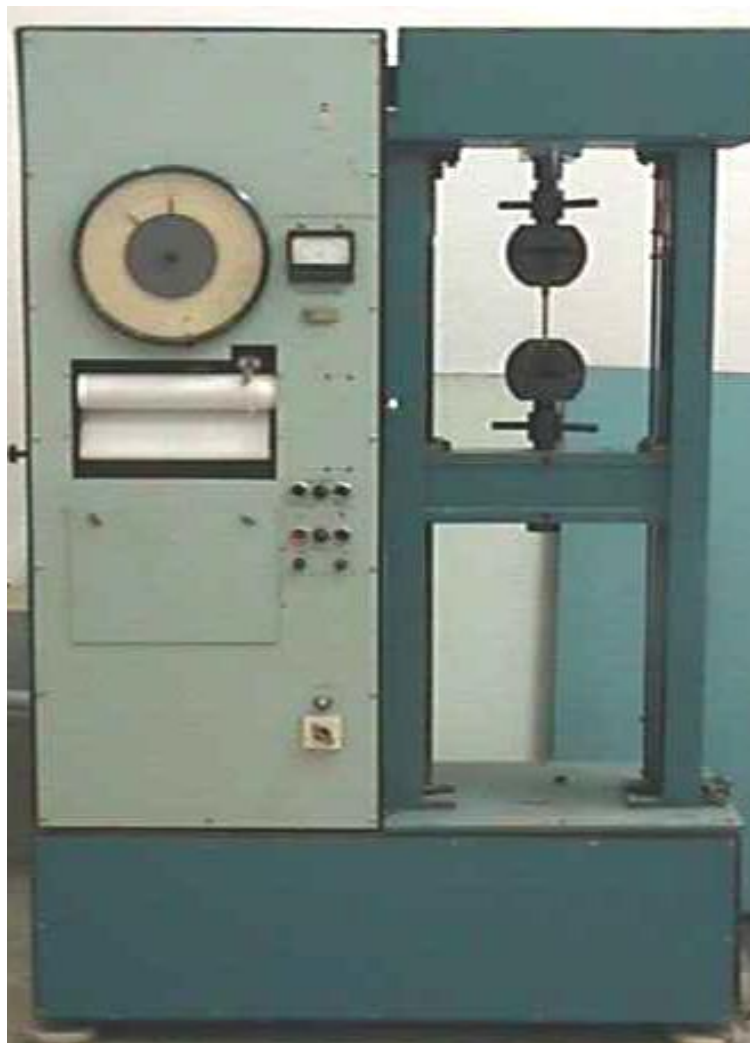
11-расм. Металлнинг чўзилишдаги мустаҳкамлигини аниқлаш учун Р-5 русумидаги машинанинг умумий қуриниши
