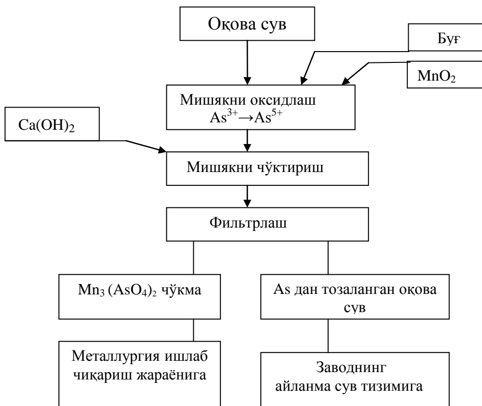
Расм. Оқова сувларни мишяк ионларидан тозалашнинг технологик схемаси
