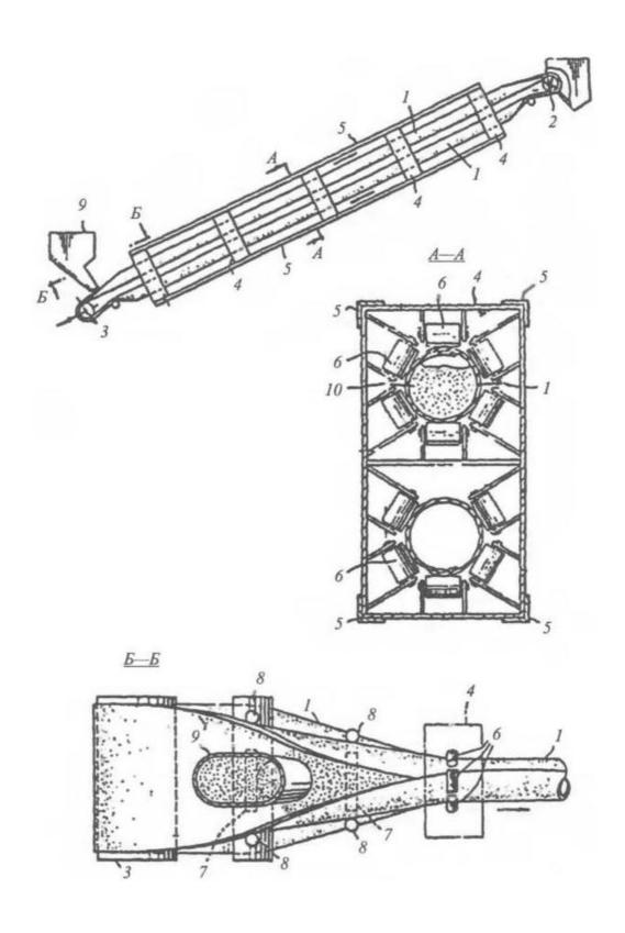
Рис. 1. Схема трубчатого ленточного конвейера:
