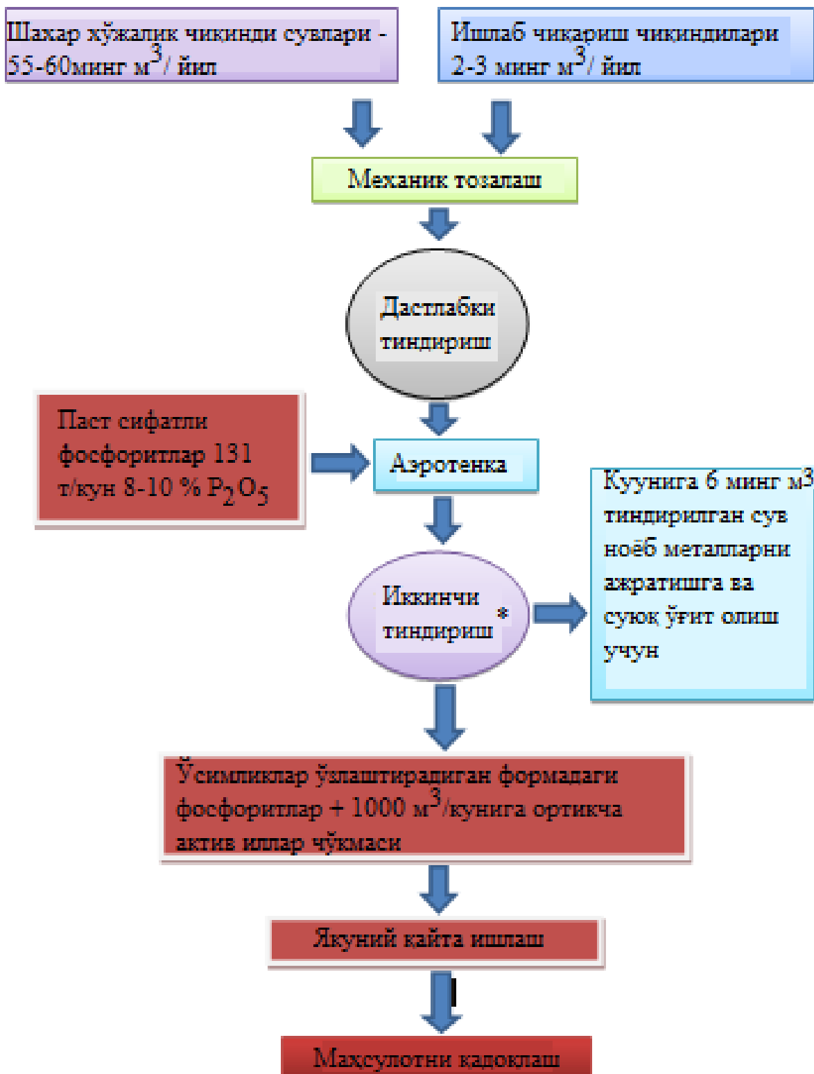
15-расм. Органоминерал ўғит олишнинг принципиал технологик схемаси (* - коагулянтлар қўшилиши мумкин)
